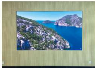
충북테크노파크 첨단반도체기술융합관 (3200x1920mm, P1.53, 캐비닛 20개 )
